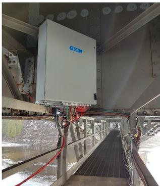
L'un des deux systèmes d'acquisition de données sur mesure installés sous le pont Alexandra.
